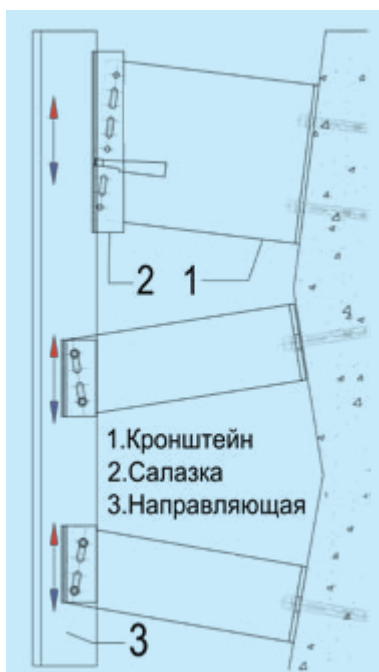
Рис. 3. Компенсация неровностей стены по вертикали в системе КТС-1 (высокопрочная)
